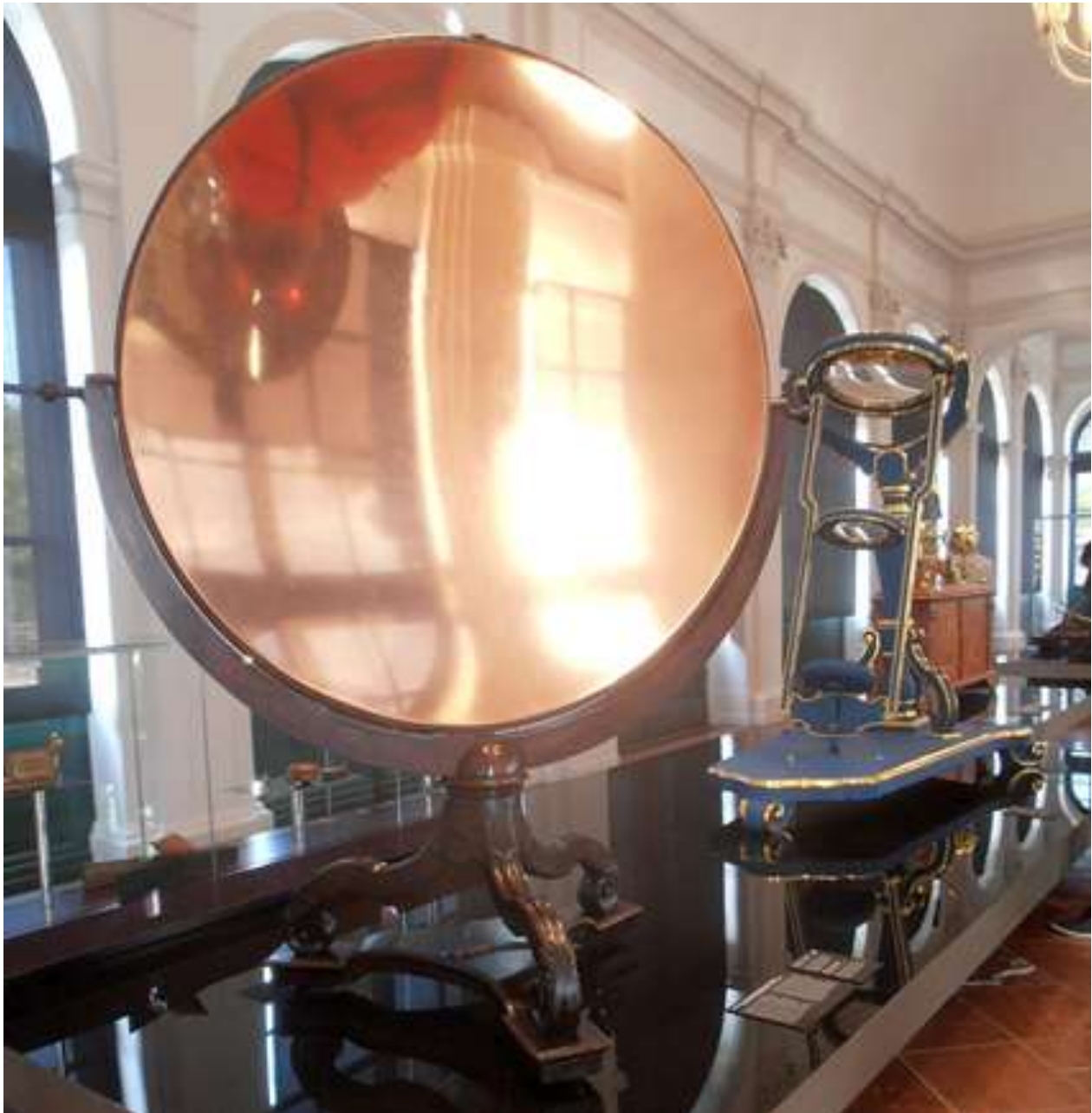
Sphärischer Brennspeigel von Tschirnhaus aus dem Jahr 1686 im Mathematisch-Physikalischen Salon in Dresden. Im Hintergrund steht einer seiner Brennlin sen-Apparate.
