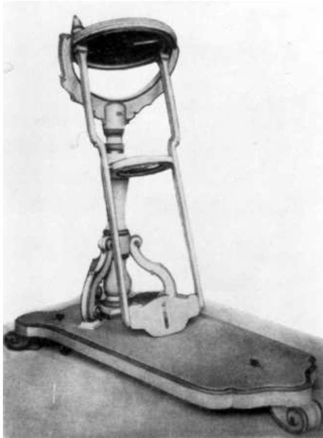
Größter Brennlinsen-Apparat von Tschirnhaus (Höhe 2,23 m).
