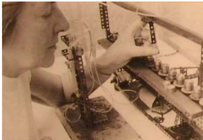
Ehfrau Wichterles sitzt am Gerät zur Herstellung von Kontaktlinsen. Foto: Archiv der tschechischen Akademie der Wissenschaften
